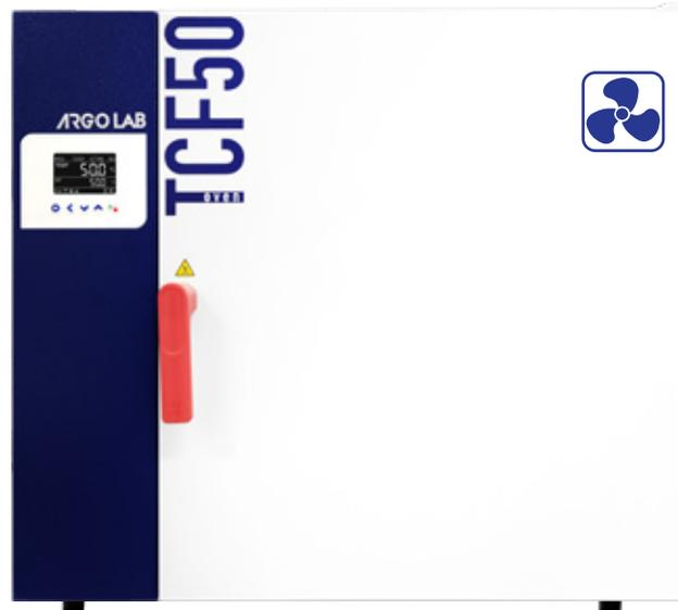
Conforme alla Classe di sicurezza 3.1 (DIN 12880), la stufa include un regolatore di temperatura massima a espansione di fluido e un foro integrato (Ø 5 mm) per l'inserimento di sensori esterni, assicurando il controllo e la certificazione della temperatura interna. Una soluzione versatile e sicura, perfetta per le applicazioni più esigenti.
