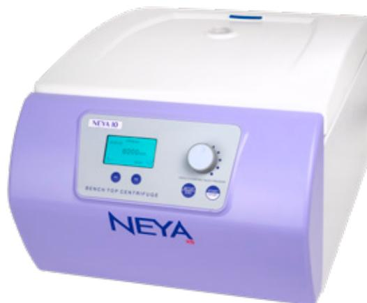
**Blocco automatico del coperchio** con possibilità di recupero delle provette in caso di mancanza di energia elettrica.
