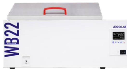
I modelli WB 22 Pump e WB 40 Pump montano una pompa di ricircolo per una perfetta uniformità della temperatura
