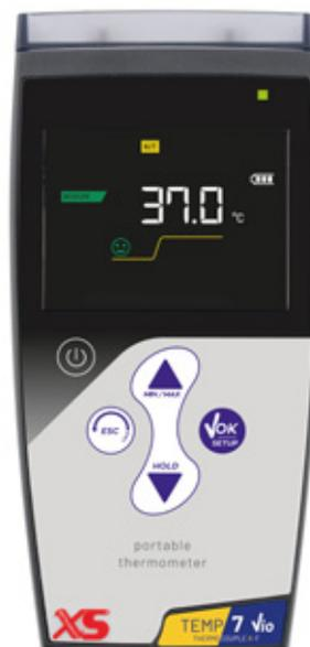
Termometro portatile, per termocoppie K/T, con display retroilluminato a colori.
