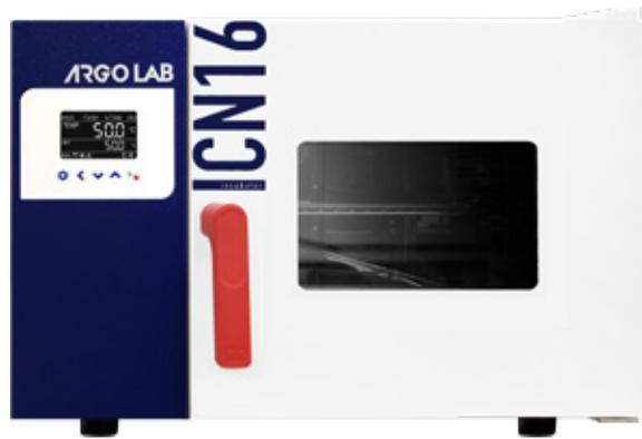
L'incubatore ArgoLab versione PLUS è dotato di un display LCD retroilluminato nero che consente la visualizzazione simultanea di tutti i parametri principali, tra cui la temperatura reale e quella impostata. Il sistema di allarmi visivi e acustici è facilmente tacitabile, e l'incubatore include una porta USB per lo scarico dei dati.
